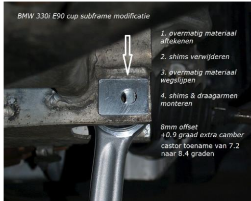
Afbeelding 3: rear lower arm offset lock-plates
